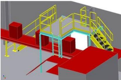
Sécuriser les convoyeurs et les manipulateurs d'anodes par l'ajout de protecteurs fixes conformément aux normes de la CSST.
